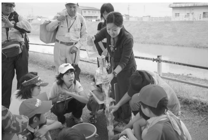
▲手作り透視度計で透視度測定中
